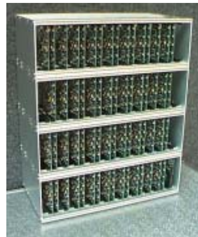
Bilder: links Softwareoberfläche mit akustischer Live Preview auf Bewegt-Video (zwei strahlende Lautsprecher); rechts 256-Kanal-Prototyp (noch ohne Frontblende)
