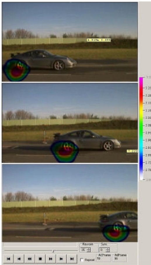
Akustische Heckemission am Porsche 911. Ausschnitte aus einem akustischen Film.
