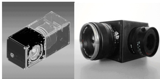
Bilder: Oben: Strahlengang; Links: Halbtransparentes 3D-Modell des Littrow-Spektrometers, Rechts: Kamerahaus mit geöffnetem Kollimator (links) und Frontobjektiv (rechts)
