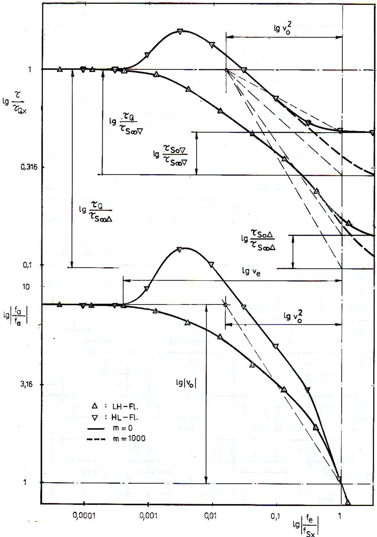
Abb.6.7-1: Unsymmetrie beider Flankenrichtungen beim 6-fach NAND NA6. Die Normierungsflankensteilheit  $f_{Sx}$  ist die der Sprungantwort der Flankenrichtung unter dem aktuellen Lastfaktor. Gatterdaten in Anl.6.
