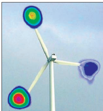
Abb.1: Blau gleich leise und rot gleich laut: Das Schallbild eines Windkraftwerkes zeigt aus einer Entfernung von 150 Metern nur noch die Schallemission der Flügelspitzen. Mit den Ohren können wir aus dieser Entfernung kaum noch ein Geräusch vernehmen, die Emission liegt unter der Rauschgrenze
