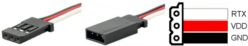
Abb.4: Für Experimente können Servostecker als SWART-Stecker genutzt werden (hier Bauart Futaba). vlnr: Stecker, Kupplung (Buchse), Layout (Sicht auf Buchse)
