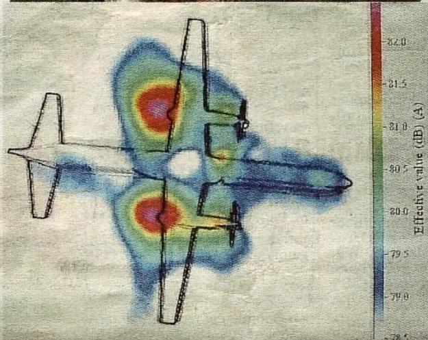
**Erfinder Dr. Gerd Heinz (49) zeigt seine akustische Kamera (Foto oben). Bei der Boeing 737 sieht man auf dem Foto genau, dass der größte Lärm von den Triebwerken ausgeht (Foto rechts)** Fotos: pemú/promo
