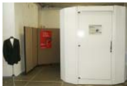
Abb. 3: 3D-Messkabine zur berührungslosen Erfassung von Körpermaßen
