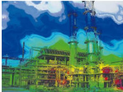
Sichtbarer Lärm. Eine akustische Kamera aus Berlin bildet Lärm farblich ab. Sie hilft, Maschinen, Autos und Industrieanlagen leiser zu machen. -
