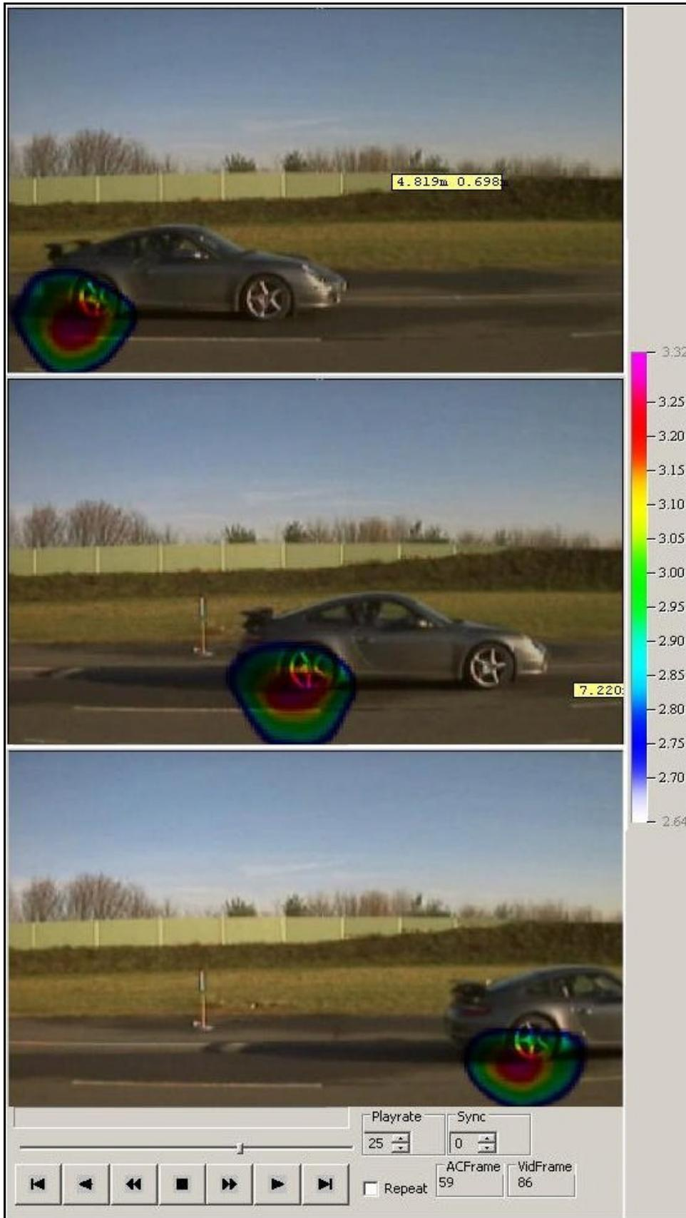
**Bild 7: Filmausschnitt einer ersten MoM-Aufnahme. Vorbeifahrt eines PKW auf der Versuchsstrecke der Porsche-AG, D. Döbler / A. Meyer, GFal Berlin sowie S. Mayer, Porsche; 23.11.2004**
