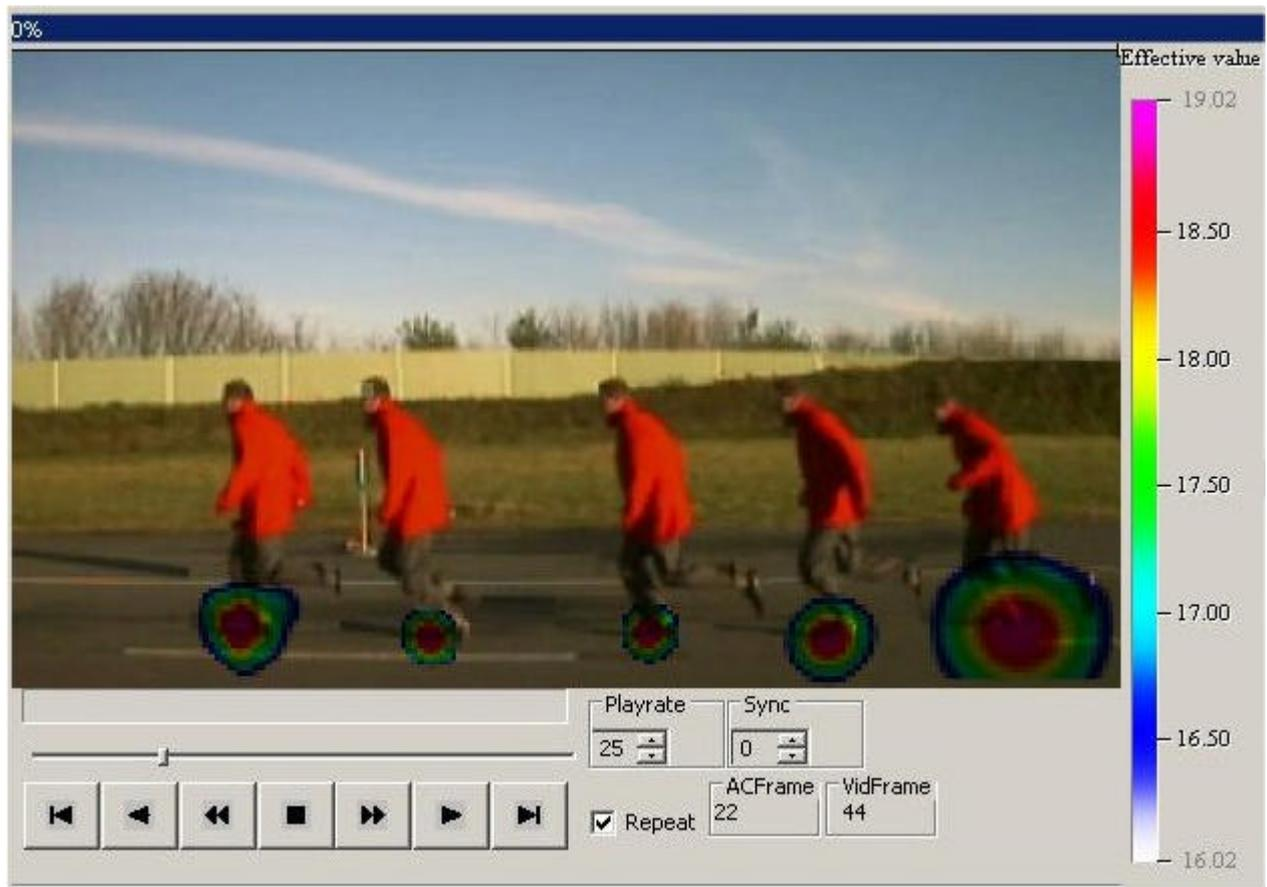
**Bild 8: Filmausschnitt einer MoM-Aufnahme: Schrittgeräusch eines Vorbeilaufenden.**
