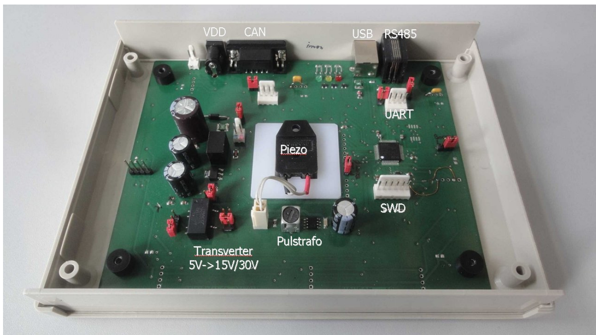
Abb. 9: Gerät in maximaler Ausbaustufe mit Piezo-Lautsprecher und Pulstransformator. Zu erkennen sind Anschlüsse für CAN, USB, RS485 und Betriebsspannung (VDD 5...24V). Die Lautsprecher-Treiberspannung kann mit Transverter wahlweise 5V, 15V oder 30 Volt betragen.
