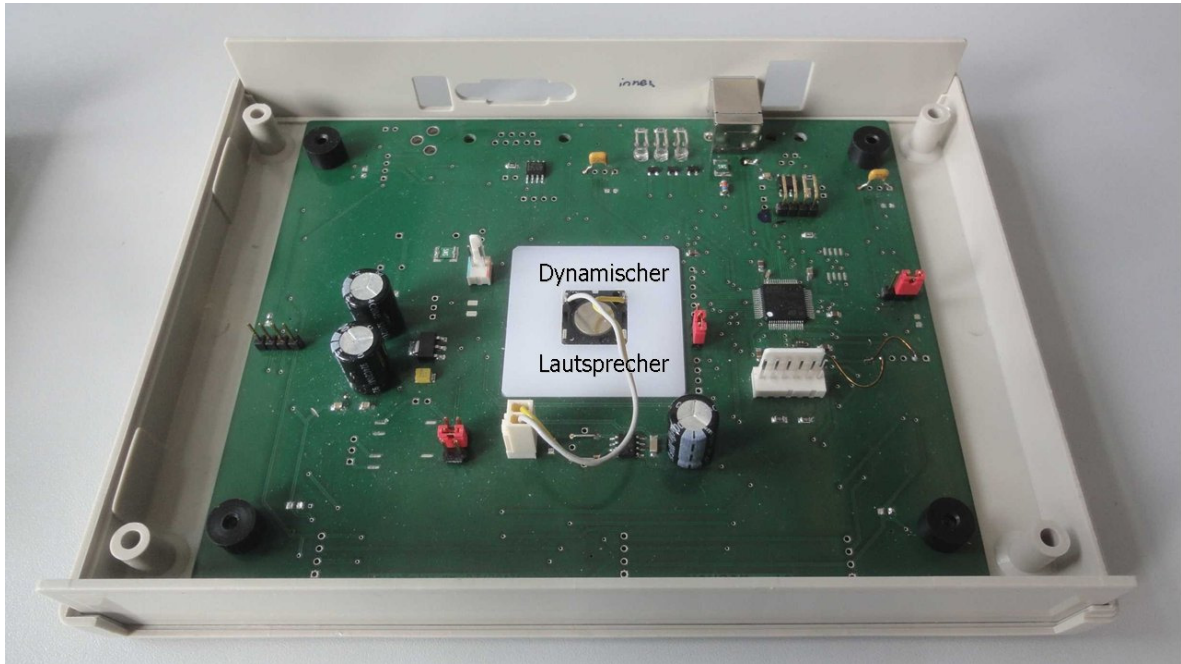
Abb. 8: Gerät in Minimalausstattung (USB) mit dynamischem Lautsprecher und direkter Speisung mit 5 Volt über USB- Buchse. Alle Bauteile befinden sich auf dieser Leiterplatte. Die Mikrophone liegen hinten.
