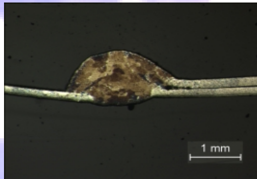
Überlapp-Kehlnah 0,20 mm Stahlblech
