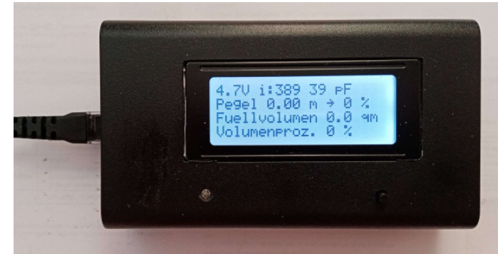
Displayeinheit mit ATmega328 (Arduino-proMini)
