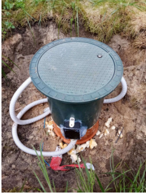
Kapazitiver Sensor am Grubenschacht mit ATtiny13
