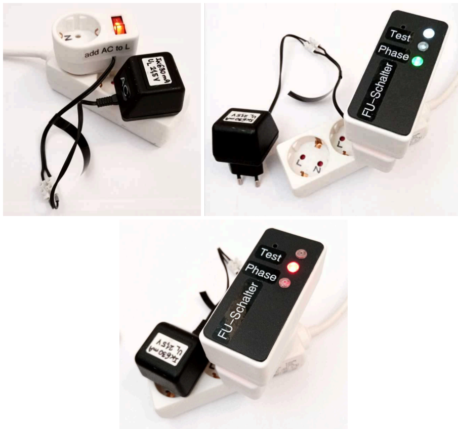
Abb.5: Inbetriebnahme. Links: Erzeugung der 250 Volt mit einem Hilfstrafo. Mitte: Wird der 20-Volt-Hilfstrafo nicht gesteckt, liegen 230 Volt am FU-Schalter. Rechts: Wird der Hilfstrafo (richtig herum) gesteckt, entstehen 250 Volt und der FU-Schalter löst aus - erkennbar an der roten LED.
