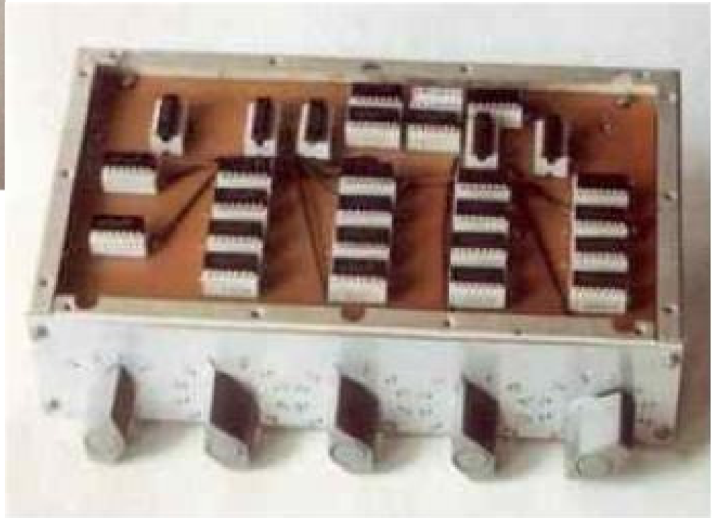
Frequenzteiler mit ersten TTL-Schaltkreisen 1970
