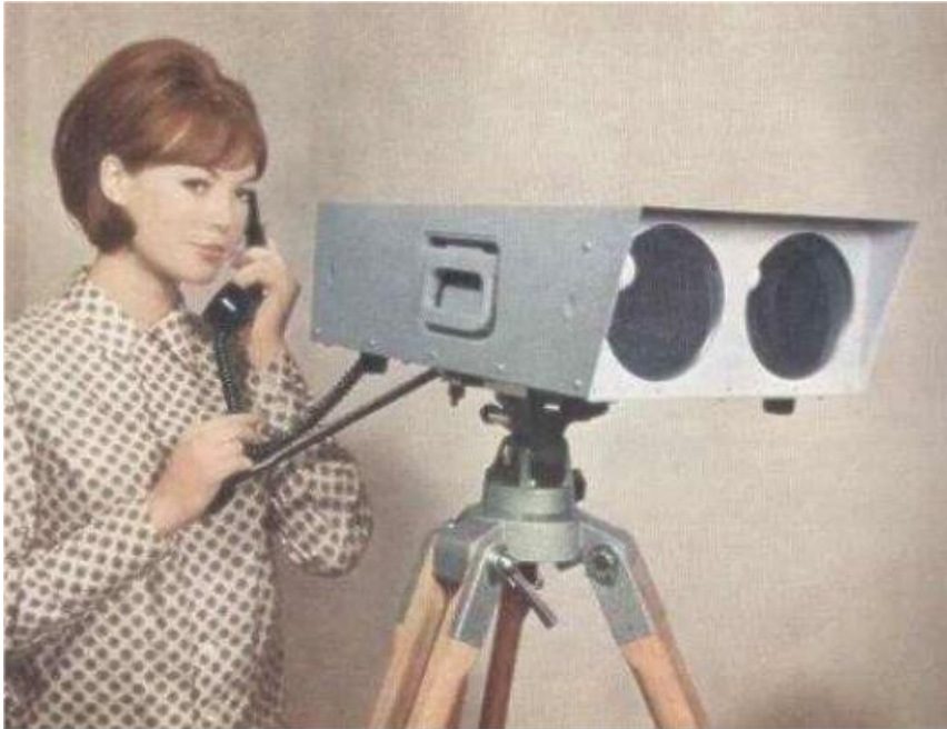
Lichtsprechgerät um 1965 5 Kanäle, Reichweite 1 km
